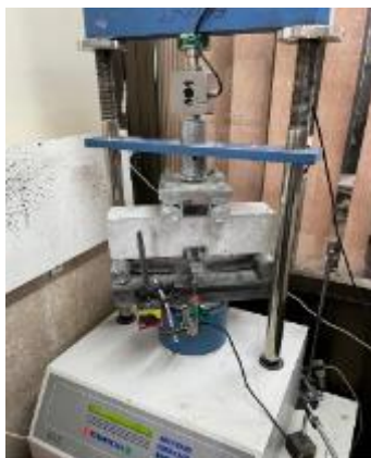
شکل ۴. آزمایش خمش چهار نقطه‌ای
