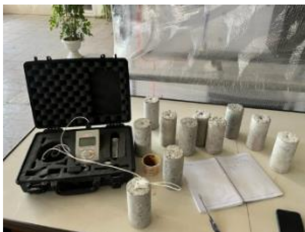
شکل ۵. آزمایش تعیین ضریب انتقال حرارتی
