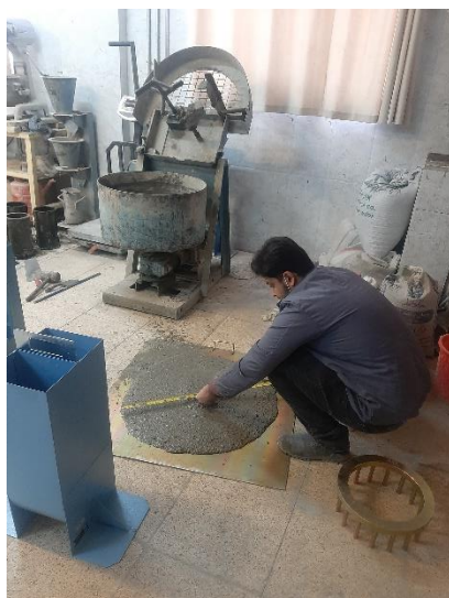
شکل ۲: انجام آزمایش اسلامپ روانی با کمک مخروط آبرامز
