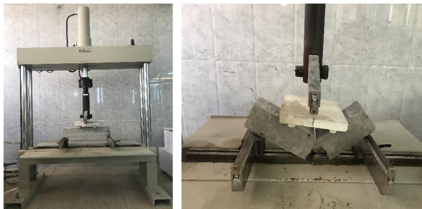
شکل ۷: نمونه گسیخته شده در آزمایش مقاومت خمشی و آزمایش مقاومت خمشی
