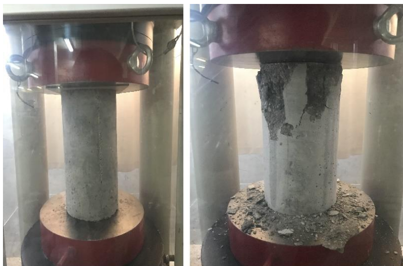
شکل ۵: آزمایش مقاومت فشاری و نمونه گسیخته شده در آزمایش مقاومت فشاری
