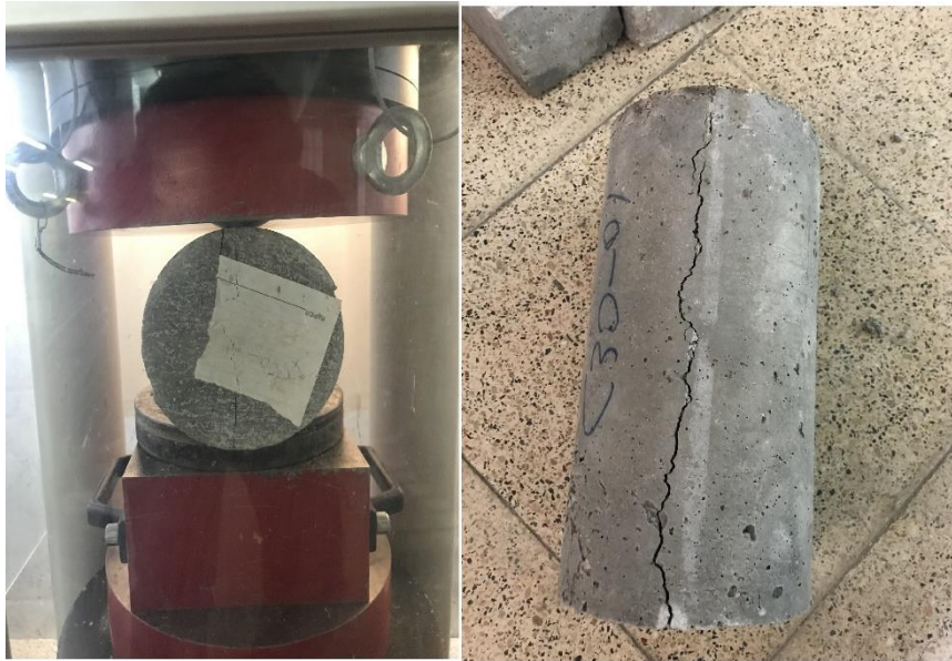
شکل ۶: نمونه گسیخته شده در آزمایش مقاومت کششی و آزمایش مقاومت کششی (تست برزیلی)
